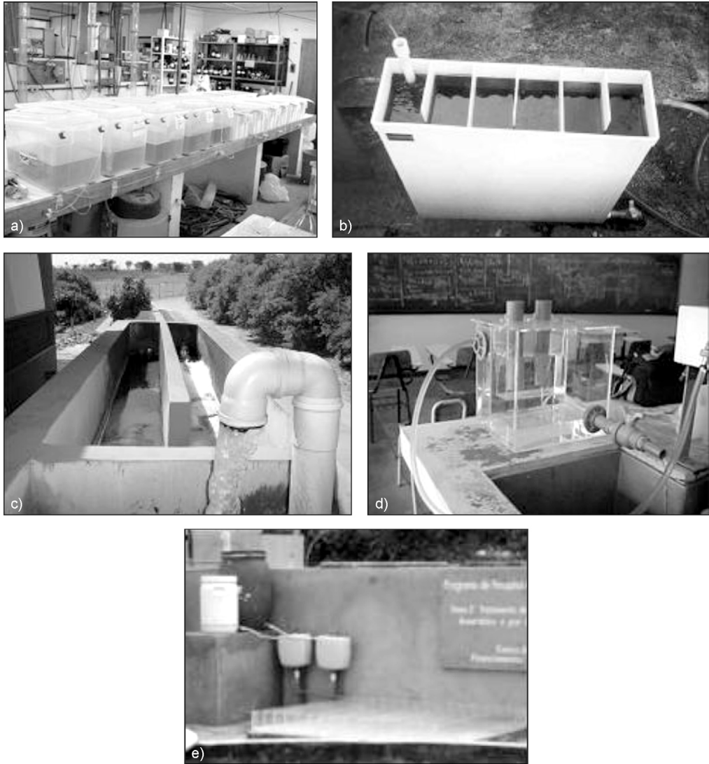
Figura 4.18 Desinfecção de efluentes sanitários aplicando hipoclorito: fotos de experimentos do PROSAB 3. a) Ensaio de toxicologia conduzido na UFRGS; b) tanque de contato piloto empregado pela PUCPR; c) tanque de contato empregado pela USP no município de Lins (SP); d) reator piloto de pastilhas de cloro empregado pela Unicamp; e e) sistema piloto de desinfecção da UFRN: dosadores e tanque de contato.
