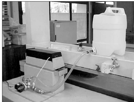
Figura 6.28 Reator UV, tipo calha, com lâmpada de 8 Watts, emersa, comprimento de onda 254 nm, em operação.
