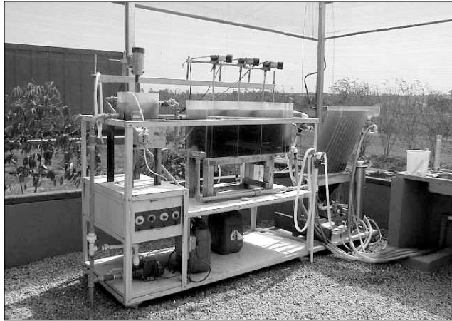
Figura 6.29 Unidade piloto utilizada para tratamento físico-químico do efluente de lagoa de estabilização.
